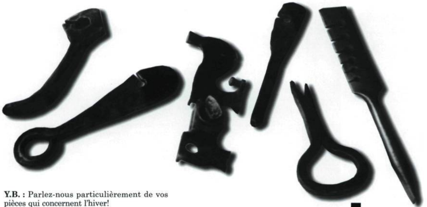
■ Série de tourne-à-gauche utilisés par l'affûteur afin de donner de la voie aux scies. (Collection André Escojido).
