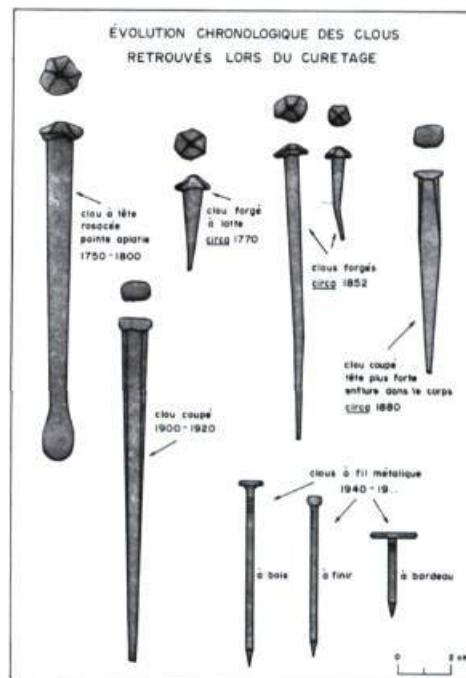
Les différents types de clous et les différentes tailles de pierre sont attribuables à une époque précise.
