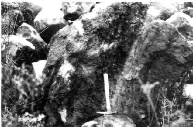
FIGURE 2. Bloc altéré M41, dont une partie est métasédimentaire et l'autre un granito-gneiss. Désagrégation de la première (épaisseur, 4 cm), alors que la deuxième demeure saine.
