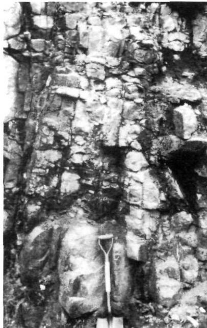
FIGURE 5. Coupe M1. Faible altération dans une anorthosite-leucogabbro. Ameublissement léger au contact des diaclases et passage brutal à la roche saine.
