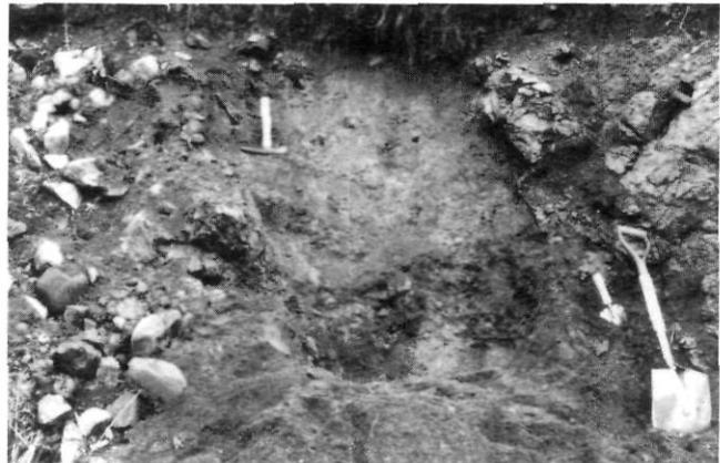
FIGURE 10. Coupe altérée M40 dans un granito-gneiss. Altération en masse de plus de 1,5 m d'épaisseur avec gradient vertical de météorisation dans une arène sableuse, ocre.
