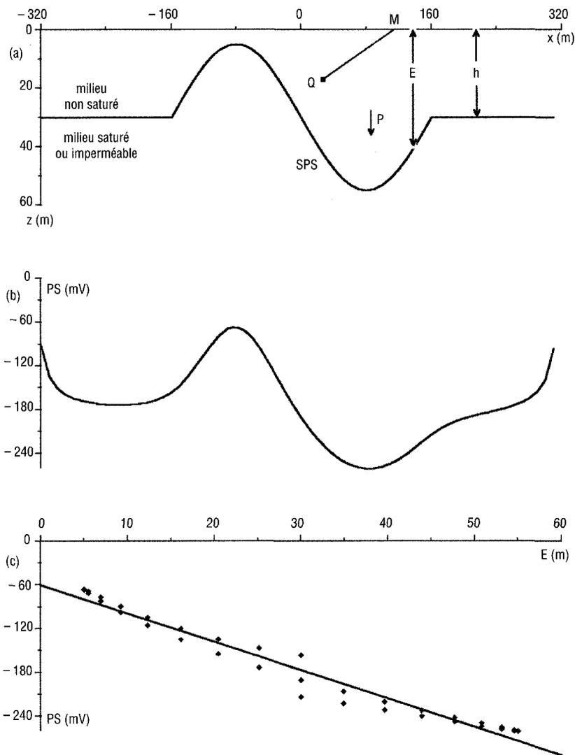
**Figure 2** (a) Modèle théorique où l'anomalie PS est créée par la polarisation du premier terrain. (b) anomalie SP calculée par le modèle polarisation ; les anomalies aux deux extrémités du profil sont des effets de bord. (c) : relation entre l'anomalie calculée (fig. b) et l'épaisseur  $E$  (fig. a) pour tous les points hors effet de bord. Les points indiquent les valeurs vraies, la droite est la droite de régression au sens des moindres carrés ( $R = 0,982$ ).
