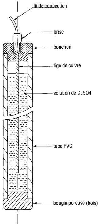
**Figure 8** Capteur PS impolarisable.
