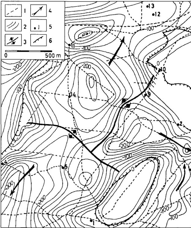
**Figure 5** Carte PS du secteur Coubert. (1) profils PS ; (2) courbe isopotentielle, équidistance 20 mV ; (3) limite entre deux bassins d'après les données PS ; (4) axe de drainage ; (5) forages de validation ; (6) limite de zone non saturée (d'après Aubert *et al.*, 1990).
