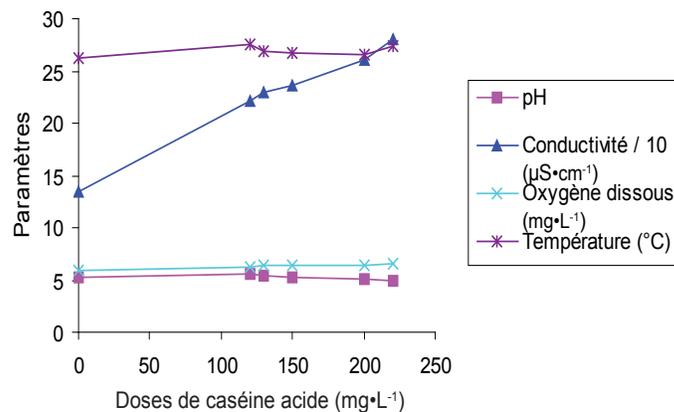
Figure 4. Paramètres physiques de l'eau traitée par la caséine acide (Échantillon 1 : eau d'Okpara; turbidité initiale 96 NTU)
