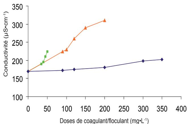
**Figure 8.** Variation de la conductivité en fonction des doses de coagulants/floculants (Échantillon 2 : eau synthétique; turbidité initiale 319 NTU). *Conductivity values as a function of coagulant/floculant doses (Sample n° 2: synthetic water with initial turbidity 319 NTU).*
