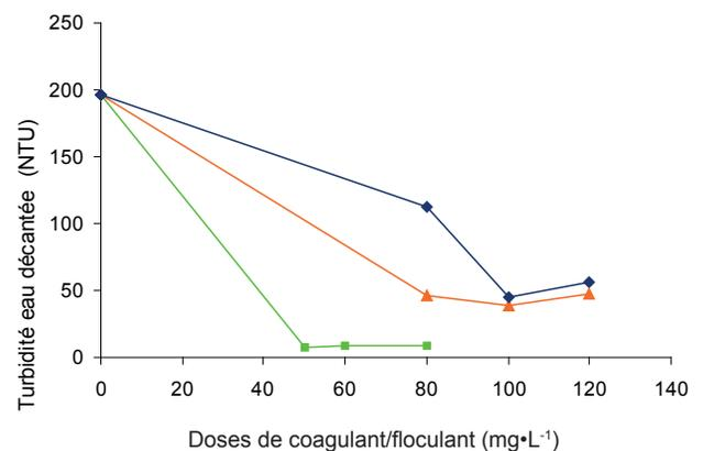
**Figure 3. Essai de type « jar-test » avec les coagulants/floculants (Échantillon 3 : eau synthétique; turbidité initiale 196 NTU).**
