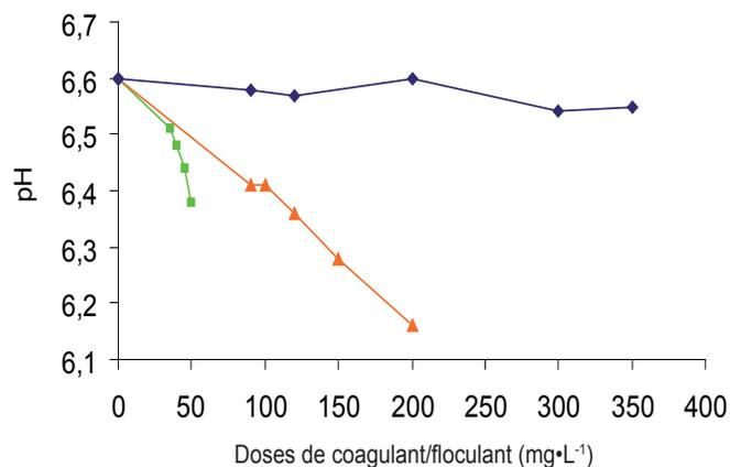
**Figure 7.** Variation du pH en fonction des doses de coagulants/floculants (Échantillon 2 : eau synthétique; turbidité initiale 319 NTU). *pH variation as a function of coagulant/floculant doses (Sample n° 2: synthetic water with initial turbidity 319 NTU).*
