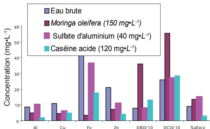
**Figure 11.** Paramètres chimiques de l'eau traitée par les coagulants (Échantillon 1 : eau d'Okpara; turbidité initiale 96 NTU).
