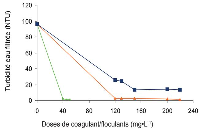
**Figure 1. Essai de type « jar-test » avec les coagulants/floculants (Échantillon 1 : eau d'Okpara; turbidité initiale 96 NTU).**
