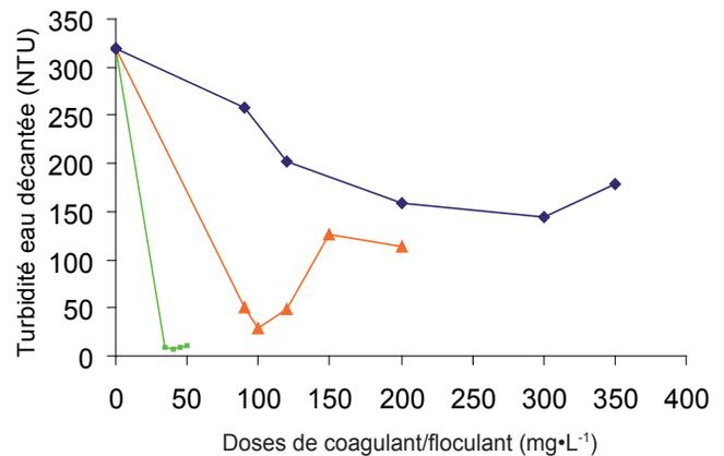
**Figure 2. Essai de type « jar-test » avec les coagulants/floculants (Échantillon 2 : eau synthétique; turbidité initiale 319 NTU).**
