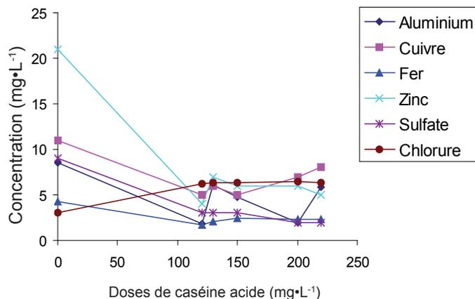
Figure 5. Paramètres chimiques de l'eau traitée par la caséine acide (Échantillon 1 : eau d'Okpara; turbidité initiale 96 NTU)
