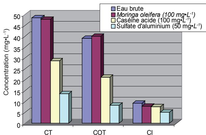
**Figure 10.** Carbone organique total (COT), Carbone inorganique (CI) et Carbone total (CT) d'eau (Échantillon 3 : eau synthétique; turbidité initiale 196 NTU).
