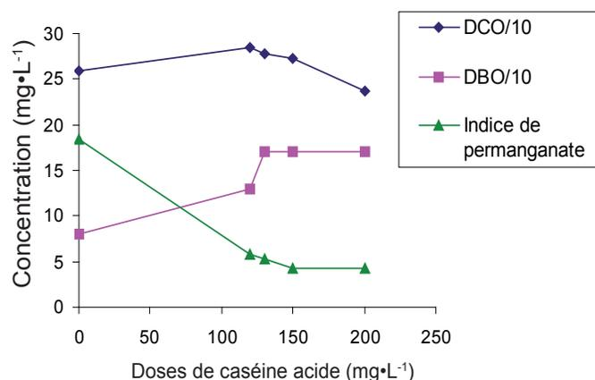
Figure 6. Variation de la DCO, DBO et indice de permanganate en fonction de la dose de caséine acide (Échantillon 1 : eau d'Okpara; turbidité initiale 96 NTU).
