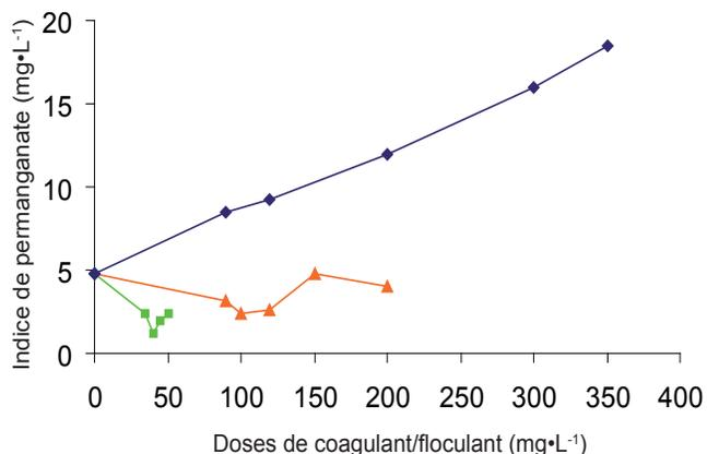
**Figure 9.** Variation de l'oxydabilité au permanganate de potassium (Échantillon 2 : eau synthétique; turbidité initiale 319 NTU).
