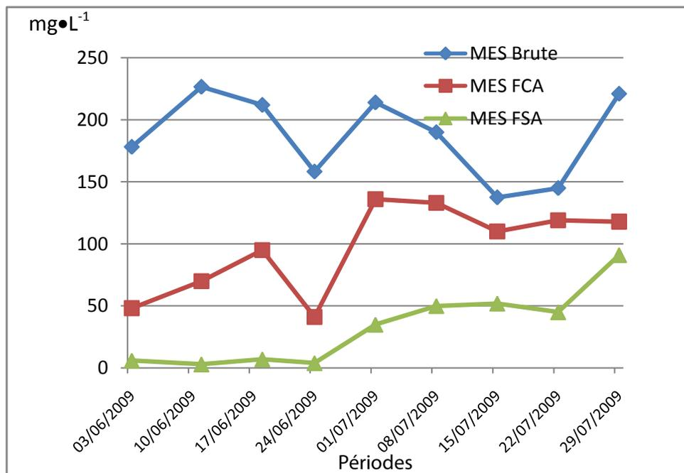
Figure 5. Évolution temporelle des teneurs en matières en suspension (MES) avec la charge hydraulique de  $20 \text{ L}\cdot\text{m}^{-2}\cdot\text{j}^{-1}$ .
