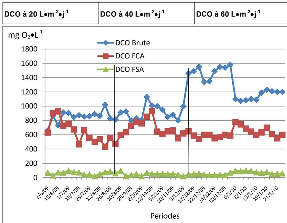
Figure 2. Évolution de la DCO avec les trois charges hydrauliques successives de 20 L•m<sup>-2</sup>•j<sup>-1</sup>, 40 L•m<sup>-2</sup>•j<sup>-1</sup> et 60 L•m<sup>-2</sup>•j<sup>-1</sup>.
