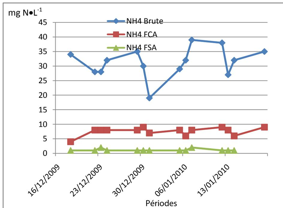
Figure 8. Variation temporelle de la concentration en ammonium pour la charge hydraulique de 60 L•m<sup>2</sup>•j<sup>-1</sup>.
