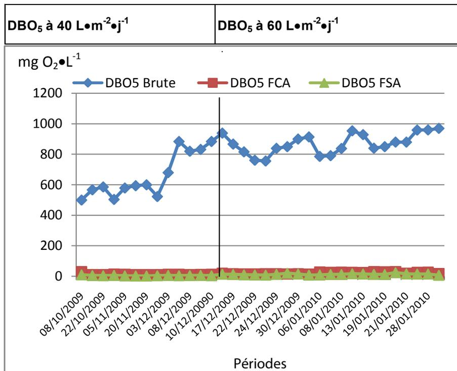
Figure 3. Évolution temporelle de la DBO<sub>5</sub> du filtre à sable aéré (FSA) et du filtre à substrat de coco aéré (FCA) avec les charges hydrauliques successives de 40 L•m<sup>-2</sup>•j<sup>-1</sup> et 60 L•m<sup>-2</sup>•j<sup>-1</sup> en rapport avec celle de l'effluent brut.
