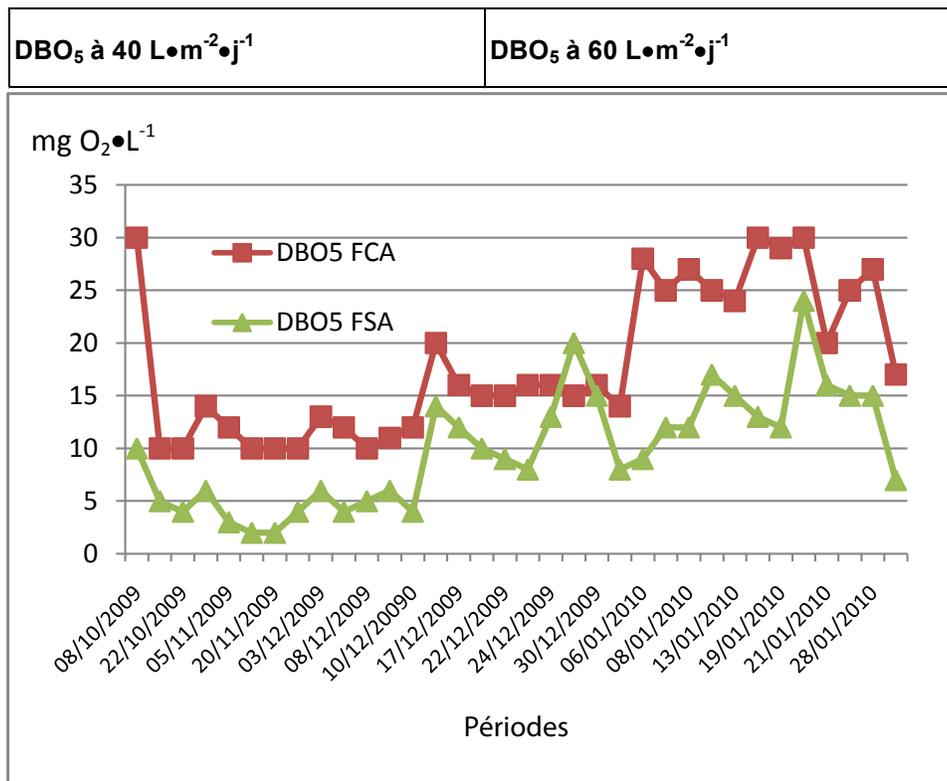
Figure 4. Évolution de la  $DBO_5$  des filtrats issus des pilotes filtre à sable aéré (FSA) et du filtre à substrat de coco aéré (FCA), avec les charges hydrauliques successives de  $40 \text{ L}\cdot\text{m}^{-2}\cdot\text{j}^{-1}$  et  $60 \text{ L}\cdot\text{m}^{-2}\cdot\text{j}^{-1}$ .
