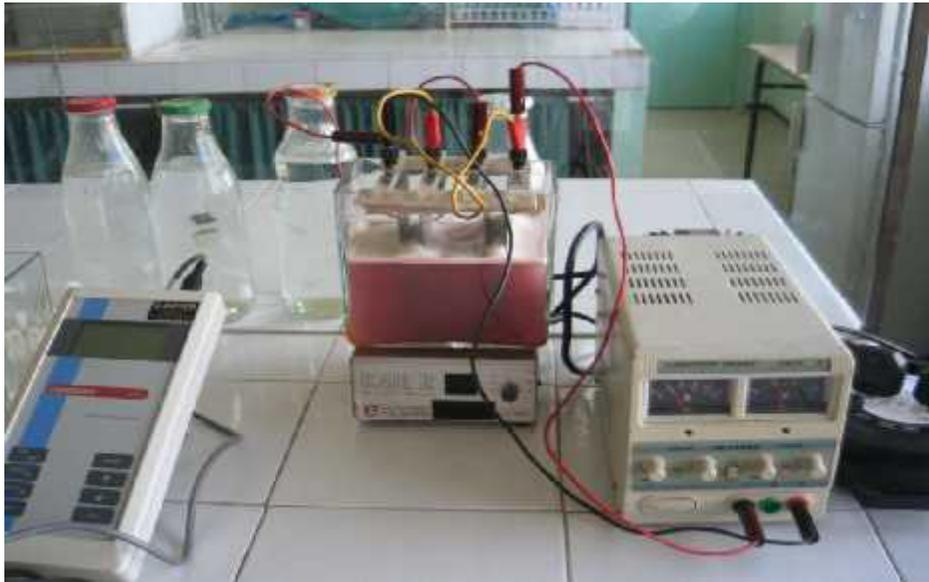
Figure 1. Dispositif d'électrocoagulation.
