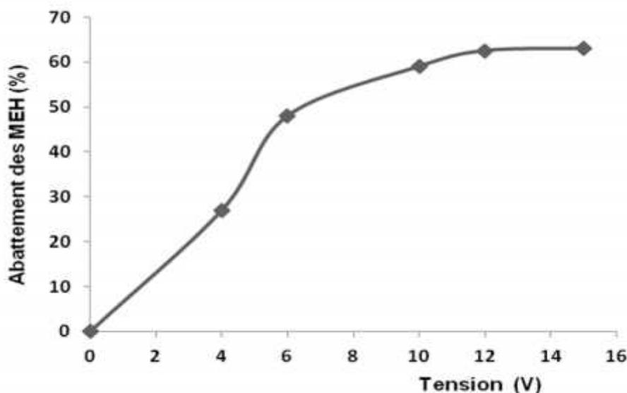
Figure 9. Abattement des huiles et graisses en fonction de la tension.
