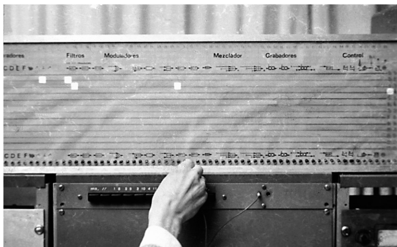
CLAEM – Instituto Torcuato Di Tella, Buenos Aires, Argentina, 1966. Touch-controlled patch-bay, designed by Fernando von Reichenbach, built with spare part from the telephone compagny (Collection de musique électroacoustique latino-américaine, Fondation Daniel Langlois).
