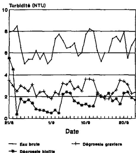
Figure 3 Mise en évidence de la biofloculation sur la biolite.
