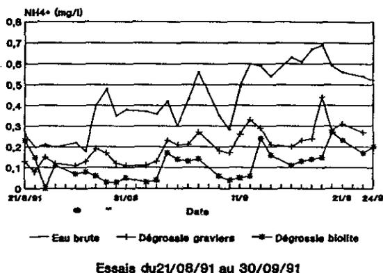
Figure 4 Mise en évidence de la nitrification biologique sur biolite.
