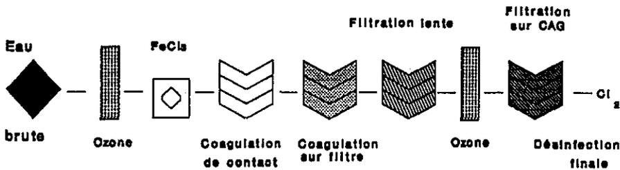
Figure 1 Schéma de la chaîne de traitement pilote.
