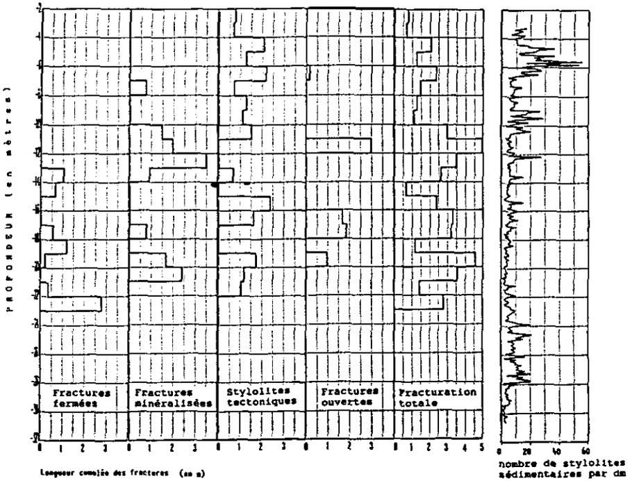
Figure 2 Répartition des différents types de fractures et des stylolites tectoniques et sédimentaires relevés sur les carottes du forage de Samson.
