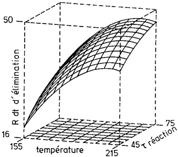
**Figure 3** Étude de la réponse expérimentale en fonction des variables T et  $\tau_{réaction}$ . Plan PE2.
