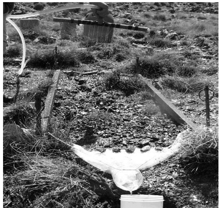
Figure1. Dispositif du test d'infiltrométrie. On distingue en haut de la placette le bidon d'eau, au dessus de la placette la rampe d'arrosage, et en bas le collecteur de ruissellement. System used for the infiltrometer tests. The water tank can be seen above the top the plot, the irrigation ramp is above the plot, and the runoff collector at the bottom.
