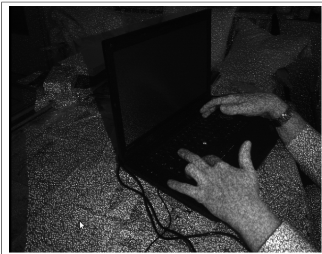
Figure 6. Motifs lumineux infrarouges projetés par la Kinect. (c) Creative Commons.
