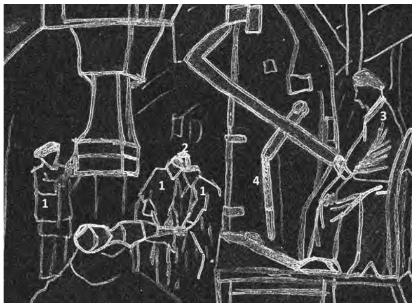
Fig. 6. Dessin interprétatif réalisé à partir d'un photogramme tiré du film Les laminoirs et les forges de Jean Tedesco (1948). © Nadège Mariotti. Les trois aides-marteleurs (1) et le marteleur (2) sont présents. Au premier plan, à droite, un ouvrier (3) abaisse et lève un levier commandant la frappe du pilon. Pour sécuriser sa machine, l'ouvrier entrave le levier par une cheville de sécurité au bout d'une chaîne (4).
