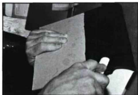
9 Les coins en cuir des plats étant posés, on y colle le papier marbré. On fait ainsi une demi-reliure, où le cuir ne couvre que le dos et une partie de la largeur des plats.
