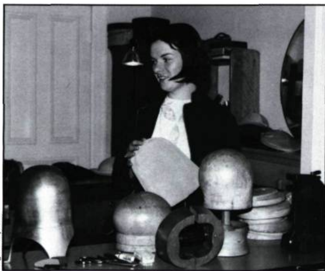
L'artisan Joa tenant un «feutre». Devant elle, des formes de bois et une forme chauffante électrique.
