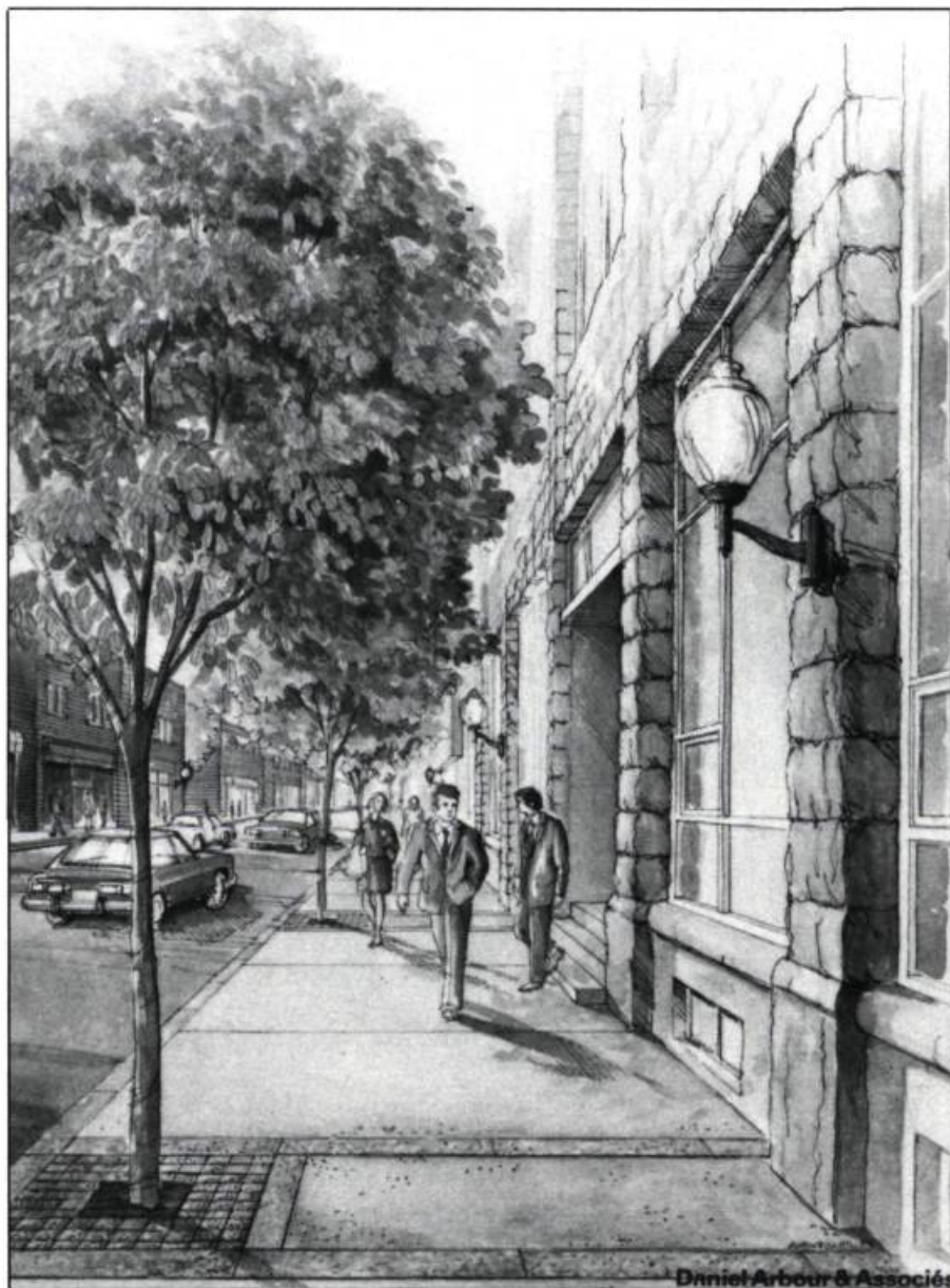
Projet d'aménagement de la rue commerciale Hériot, à Drummondville par Daniel Arbour et Associés. Le retour du piéton «urbain» et de la boutique sur rue. Ici, les trottoirs de béton sont rythmés par deux bandes de granite qui marquent l'implantation des arbres. (photo: D. Arbour et Associés)
