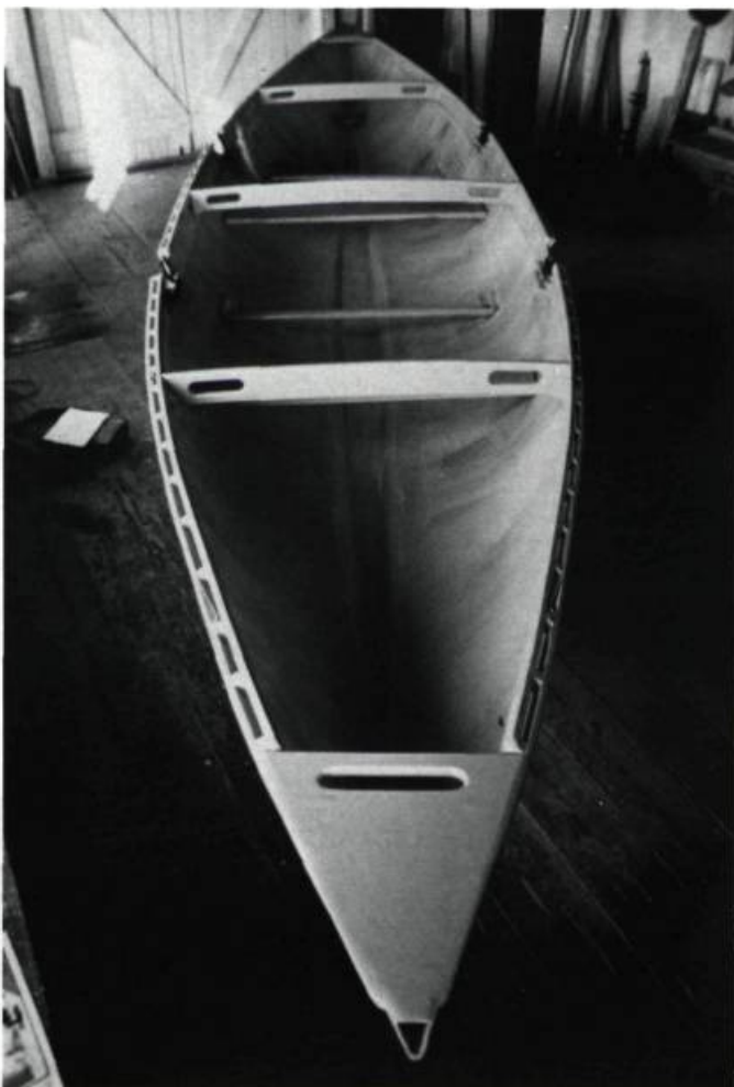
6. Le produit fini. Pour solidifier le canot, on a mis en place le bandeau, qui forme une ceinture solide à l'intérieur du navire, les barres à mains et à pieds et les bancs, qui maintiennent l'écartèlement de la coque, puis les toletières, qui accueillent tolets et rames. (photo: S. Drolet)
