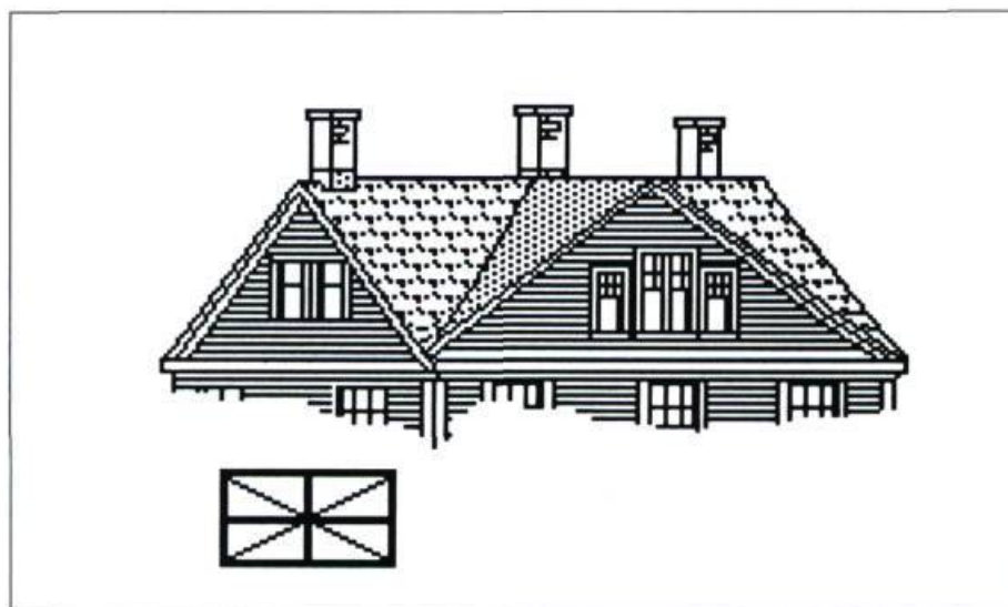
Schéma d'une maison vernaculaire à pignon central et configuration de ses lignes de toit: boulevard Queen Sud, Sherbrooke. Infographie: Gaétan Bousquet, 1987.
