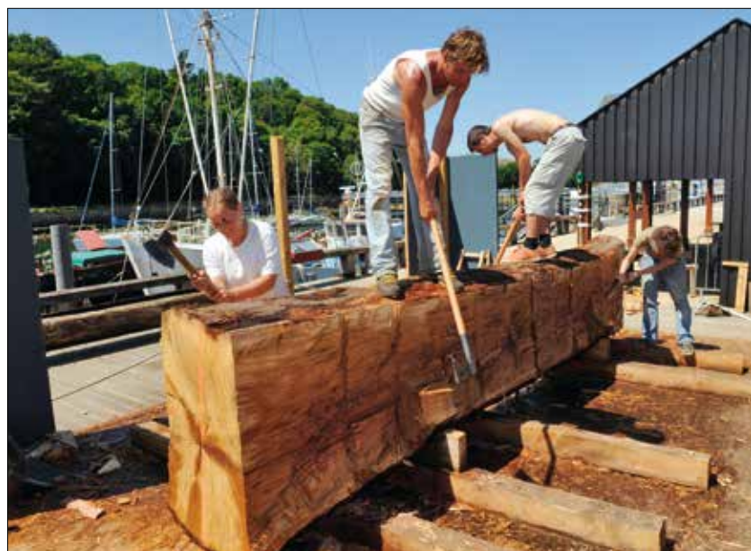
Sur le chantier naval des Ateliers de l'Enfer à Douarnenez, 11 jeunes bénévoles de divers pays ont relevé le défi de creuser à l'identique une pirogue monoxyle, sur le modèle d'une épave médiévale découverte près de Vannes en 1906.
