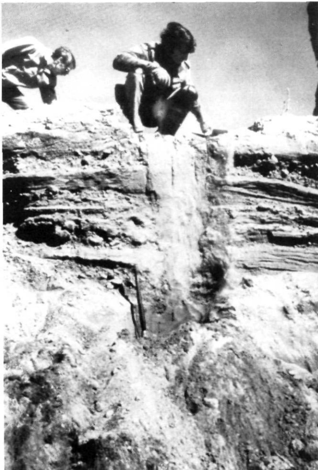
FIGURE 7. Fente de gel fossile dans le delta goldthwaitien de 130 m à Clermont. La couche de sable sommitale, qui recouvrait en discordance la fente, a été dégagée pour observer le prolongement de la structure vers l'intérieur de la coupe.
