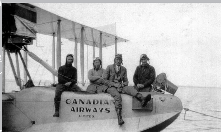
HS-2L de la Canadian Airways employé pour la photographie aérienne. (Source : Collection Louis Patrault)
