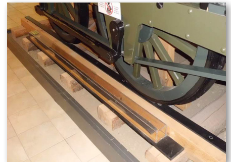
Rails de bois recouverts d'une lisse de fer, formant ainsi un « chemin à lisse ». (Source : Stéphane Tremblay)
