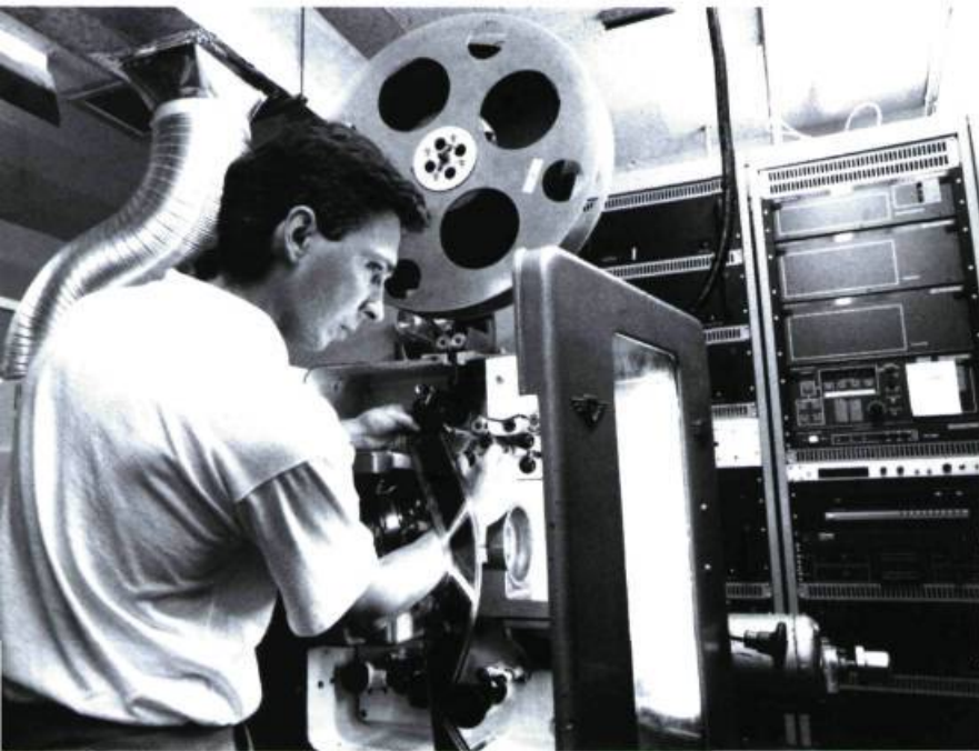
André Bergeron charge de pellicule 70mm un des deux projecteurs du cinéma Impérial. À l'arrière-plan, une partie des modules décodeur Dolby et ampli THX.
