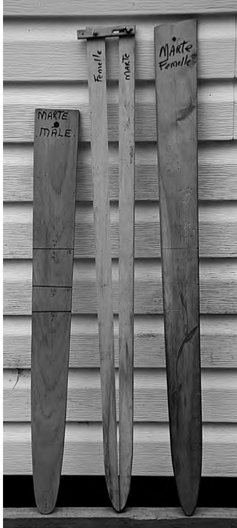
Moules à martre de Donald Kenney. Celui de gauche est fait pour le mâle et les deux autres pour la femelle. Remarquez que celui au centre est ajustable selon la grandeur de la peau.
