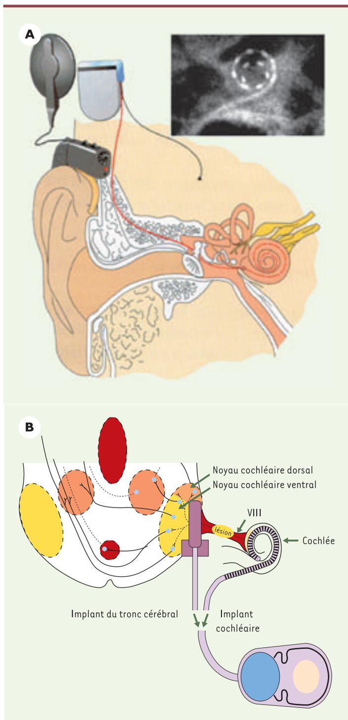
**Figure 4. Implants cochléaire et du tronc cérébral.** Ces implants se composent d'une partie externe (microphone et microprocesseur réunis dans un contour d'oreille) et d'une partie implantée soit dans la cochlée, soit dans le noyau cochléaire du tronc cérébral. **A.** Implant cochléaire (avec l'autorisation de *Colin Medel*). **B.** Positions respectives de l'implant cochléaire et de l'implant du tronc cérébral (avec l'autorisation de *Cochlear*).
