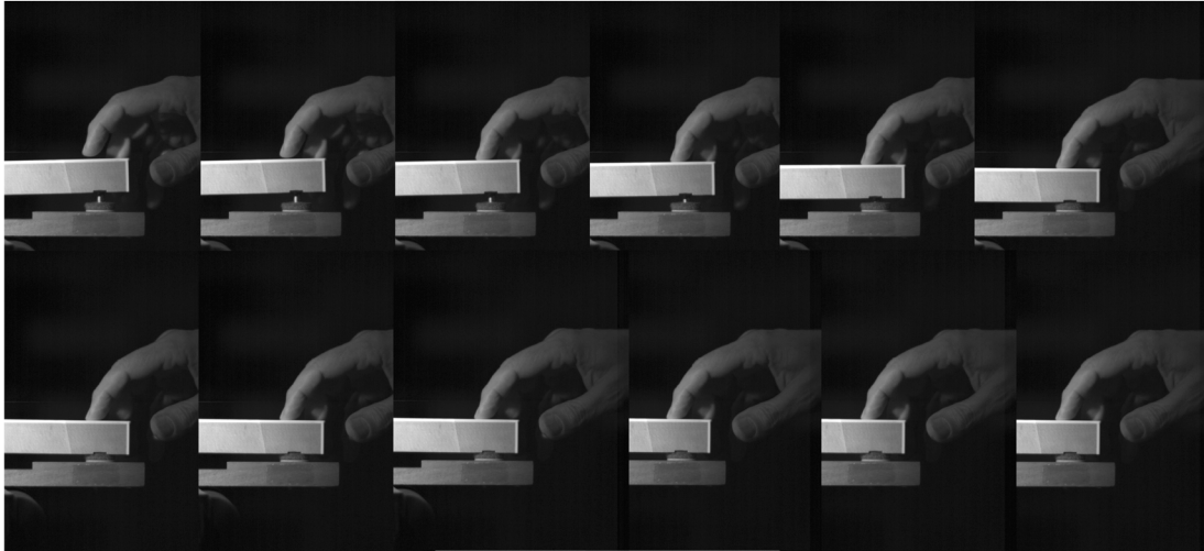
Figure 2 : Attaque de la note avec le toucher poussé, filmé en caméra rapide. Une touche modèle de piano est utilisée pour la visualisation.
