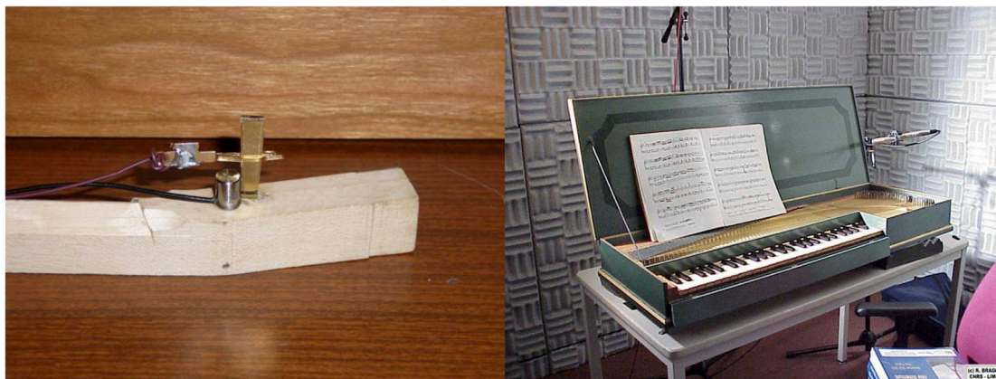
Figure 6 : À gauche, accéléromètre et contact près de la tangente. À droite, placement du microphone à 30 cm au centre de la table d'harmonie, en cabine d'enregistrement.
