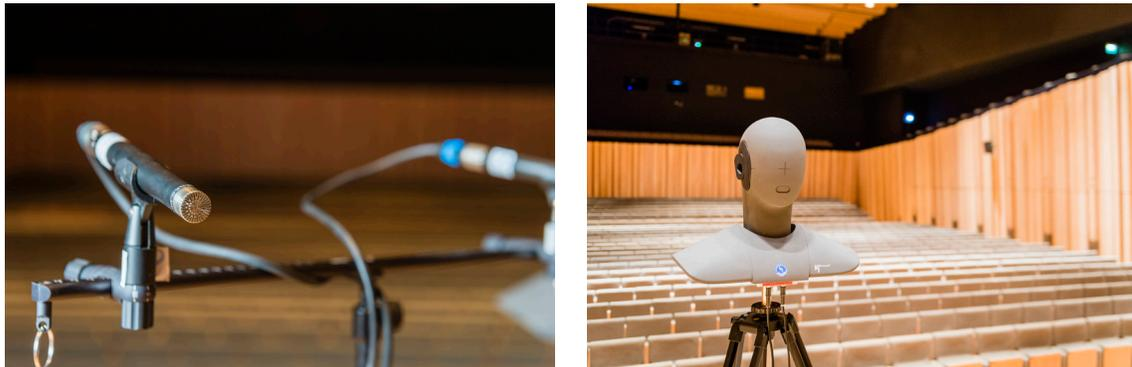
Figure 2 : Couple microphonique à gauche, tête artificielle Head-Acoustics à droite. Photos : Cyril FRESILLON / Pprime / CNRS Photothèque.
