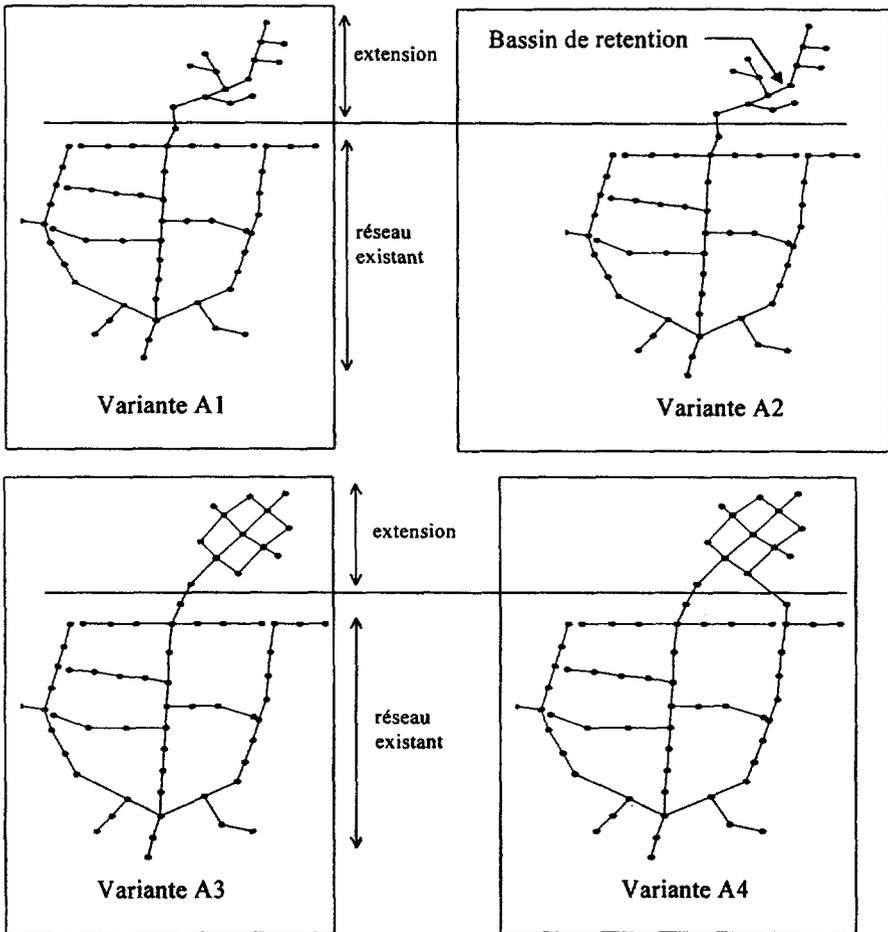
**Figure 8** Les différentes propositions d'extension du réseau existant.
