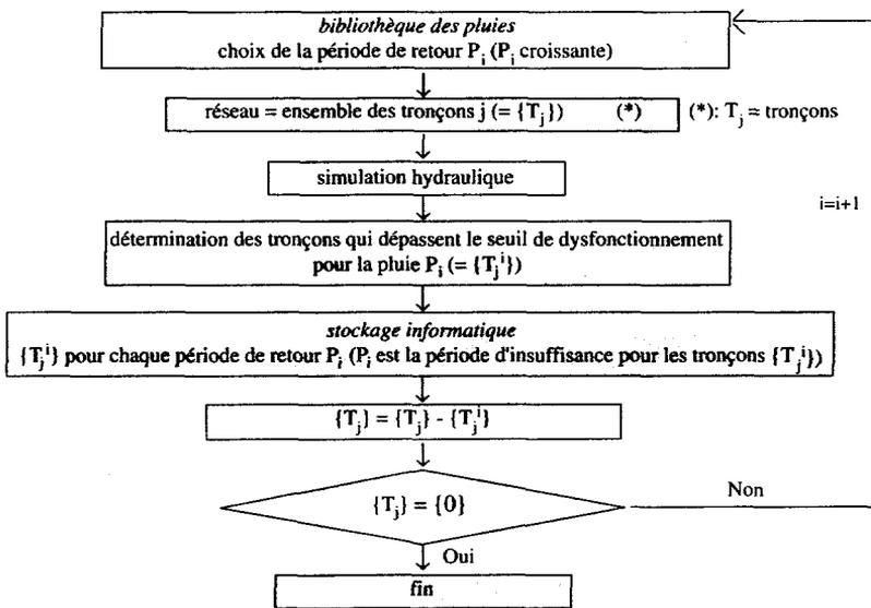
**Figure 1** Algorithme de la détermination des périodes d'insuffisance des tronçons.
