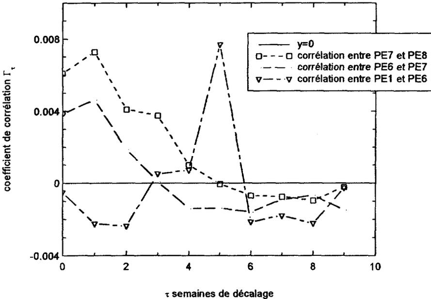
**Figure 8** Numération bactérienne : Corrélations entrée-sortie.
