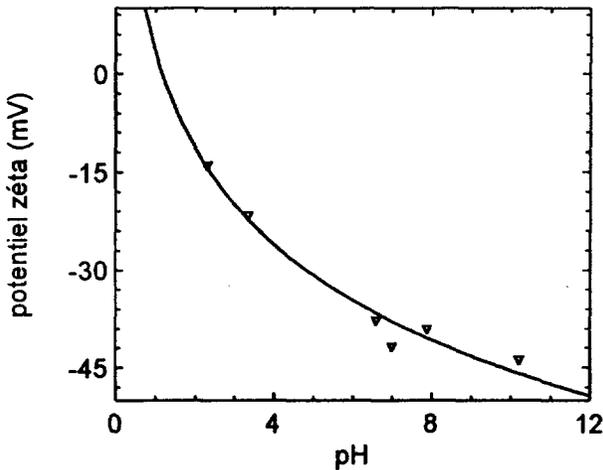
**Figure 11** Évolution du potentiel zéta des particules du dépôt en fonction du pH.
