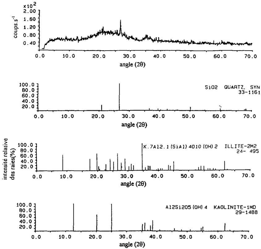
**Figure 10** Spectre diffraction X du dépôt colmatant.
