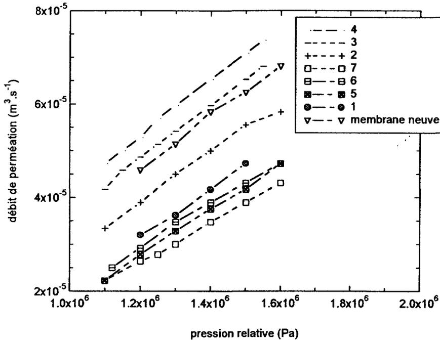
**Figure 9** Perméabilité des membranes en fonction de la pression appliquée.
