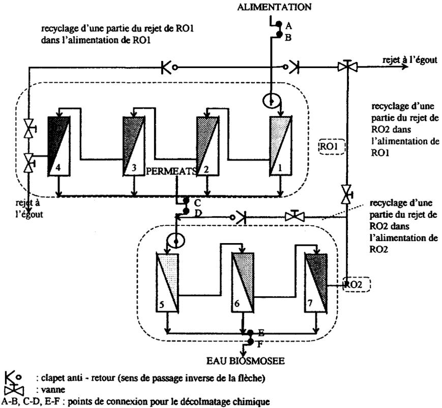
**Figure 2** Schéma Hydraulique du complexe des deux osmoseurs.
