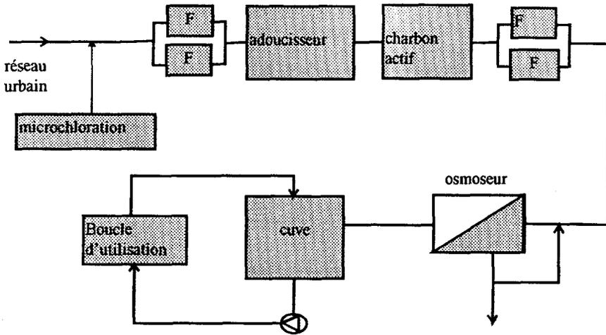
**Figure 3** Pilote d'osmose inverse.
