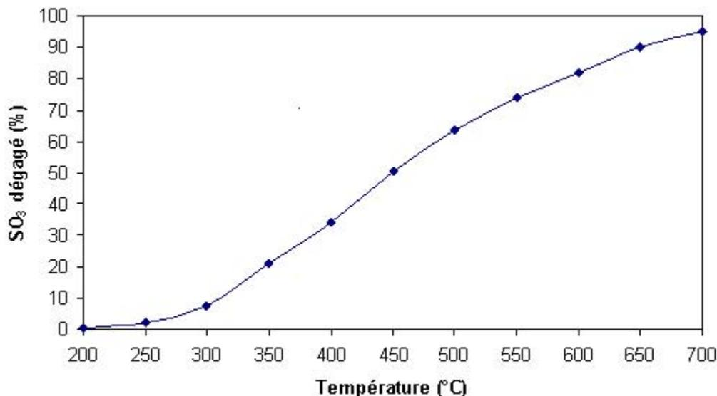
Figure 2. RAKOTOMARIA - Dégagement du gaz SO<sub>3</sub> en fonction de la température.
