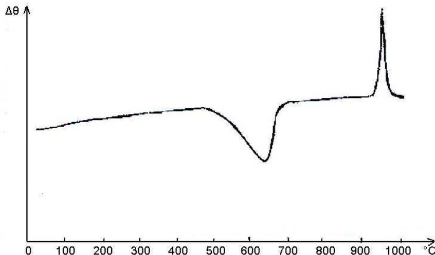
Figure1. RAKOTOMARIA - Courbe d'Analyse Thermique Différentielle (ATD) du kaolin d'Analabe.
