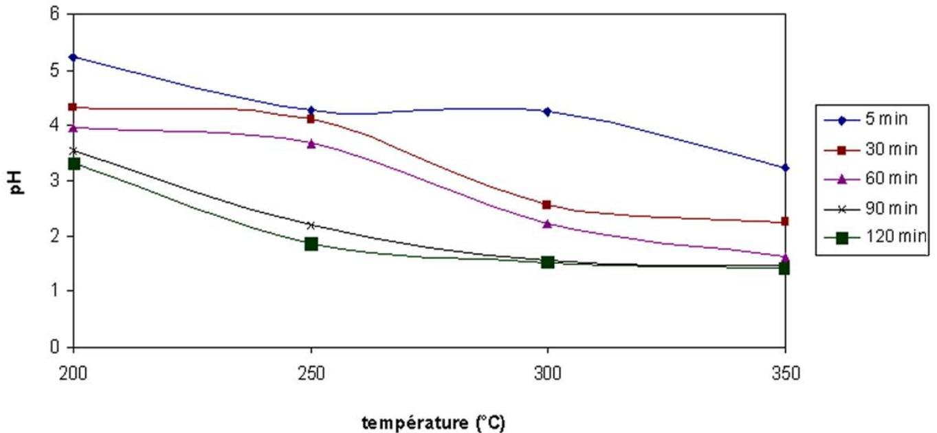
Figure 4. RAKOTOMARIA - Variation des pH des nouveaux produits en fonction de la température d'attaque.
