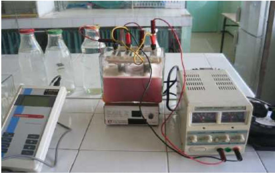
Figure 1. Dispositif d'électrocoagulation.
