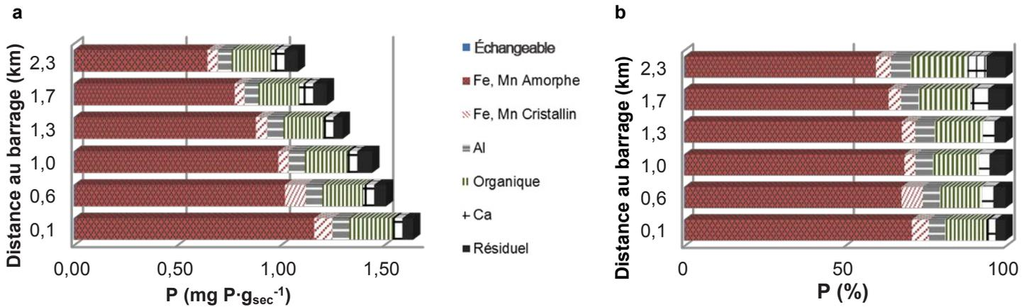
Figure 4. Évolution spatiale du fractionnement chimique du P au sein des sédiments de la retenue de Champsanglard : a) en mg P·g<sup>-1</sup> et b) en pourcentage.
