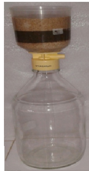
Figure 1. Colonne utilisée avec le filtre F1. Column used with filter F1.
