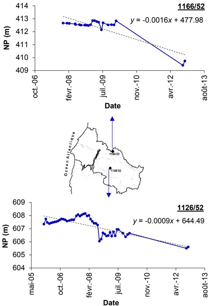
**Figure 6.** Évolution du niveau piézométrique (NP) dans les puits 1126/52 et 1166/52.
