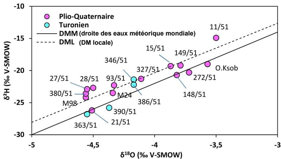
Figure 11. Corrélation  $^2\text{H}-^{18}\text{O}$  dans les eaux souterraines de la zone synclinale d'Essaouira (2006).
