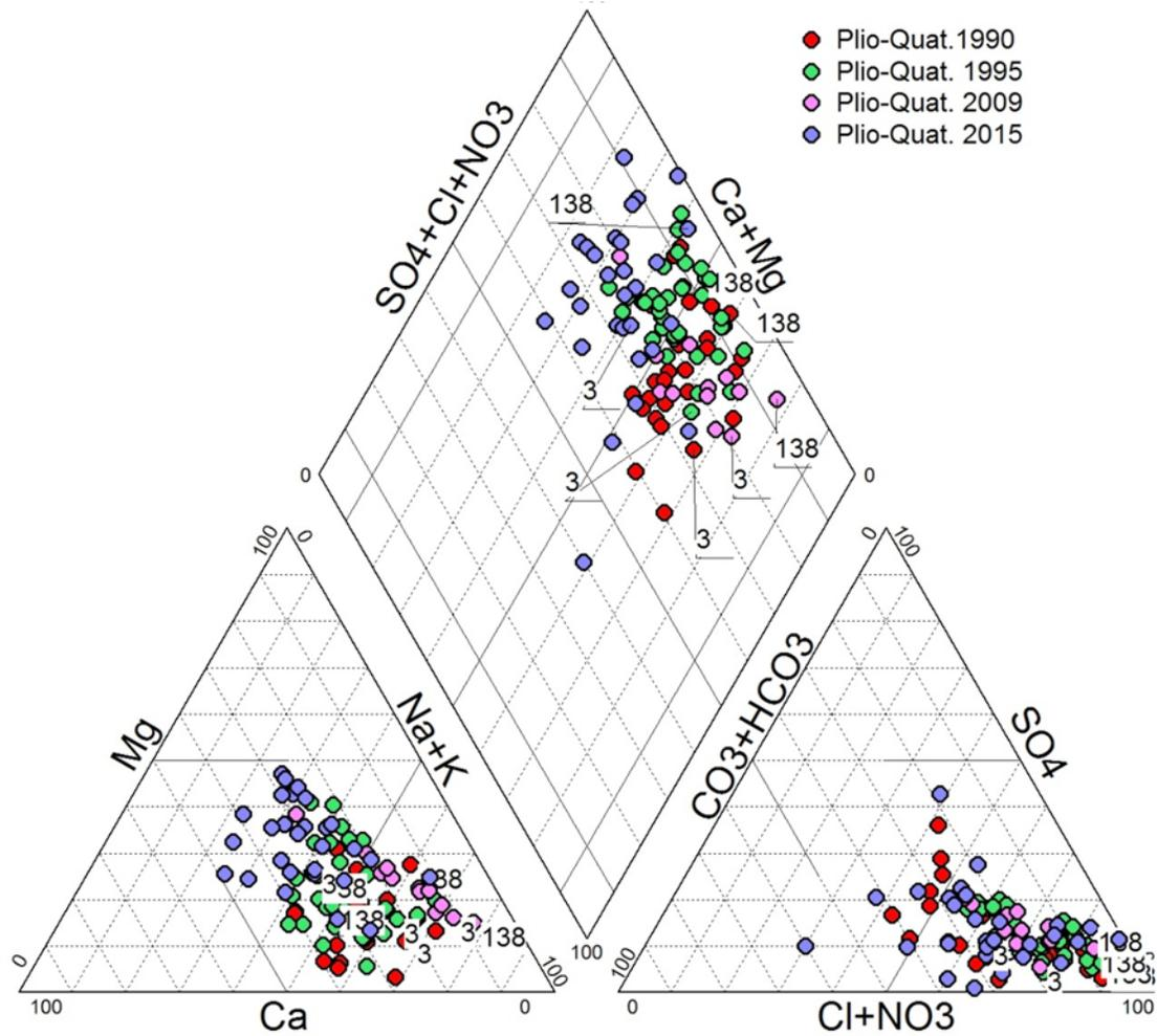
Figure 8. Faciès chimique des eaux de la nappe plio-quaternaire en 1990, 1995, 2009 et 2015.
