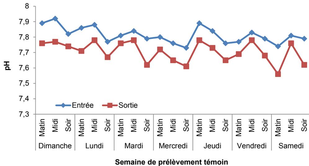
Figure 9. Évolution journalière du pH de l'effluent à l'entrée et à la sortie du bassin de filtration.
