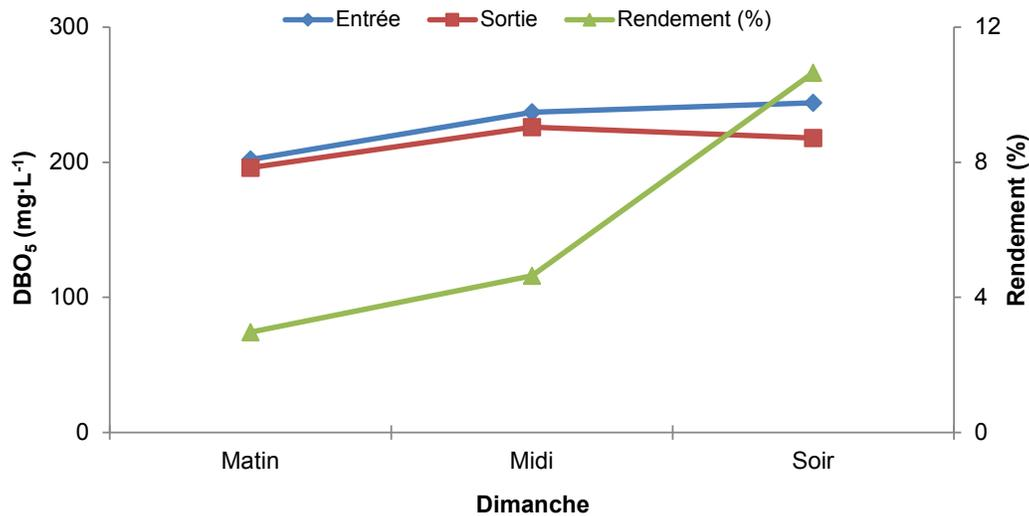
Figure 13. Évolution au cours de la journée du dimanche de la demande biologique en oxygène à cinq jours ( $DBO_5$ ) à l'entrée et à la sortie du bassin de filtration et de son rendement épuratoire. *Evolution on Sunday of the 5-day biological oxygen demand ( $BOD_5$ ) at the inlet and outlet of the filtration basin and of its treatment efficiency.*
