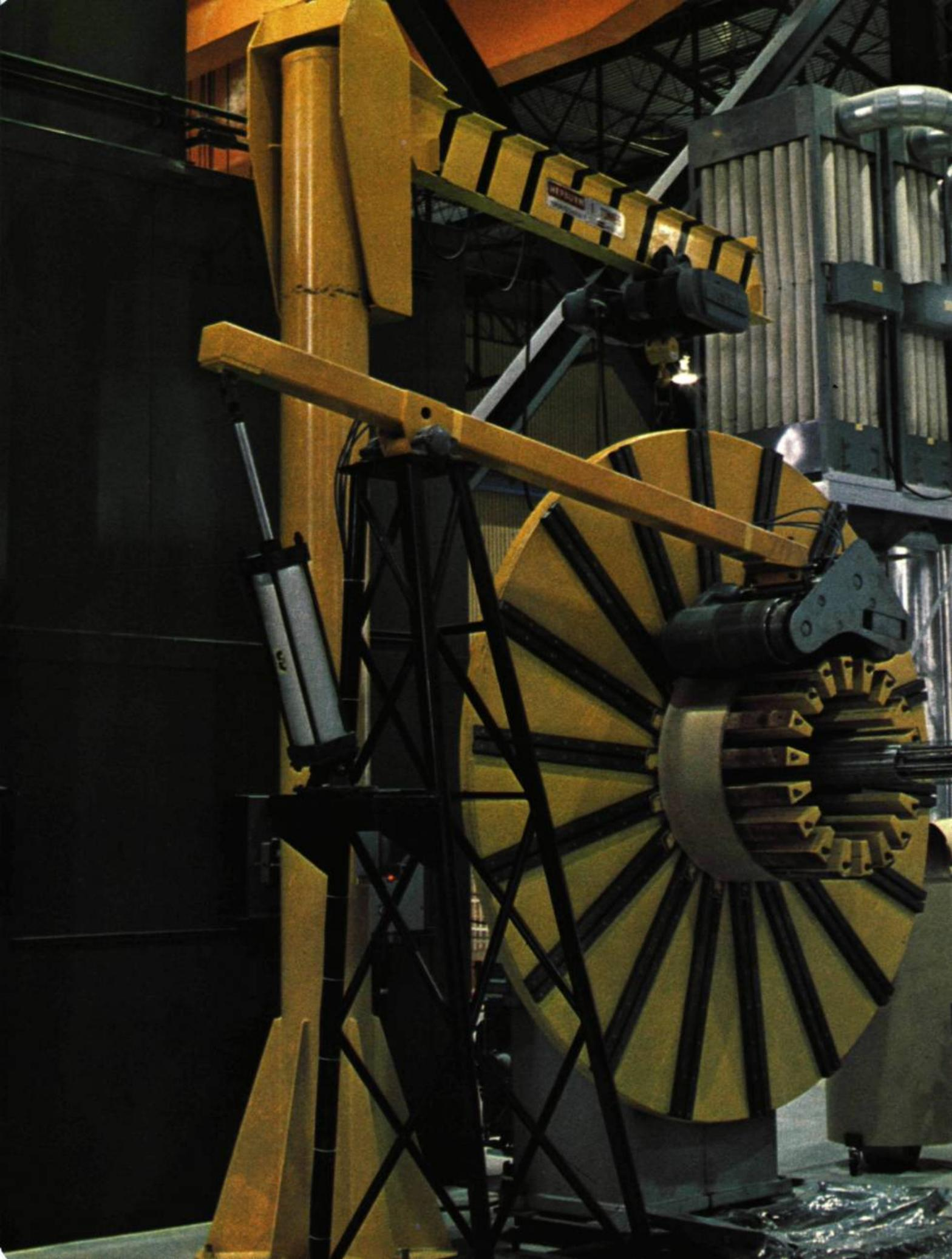
1. Machine à fabriquer les bagues, située à proximité de l'atelier d'isolation. Les bagues sont l'une des parties composantes d'une bobine de transformateurs.
