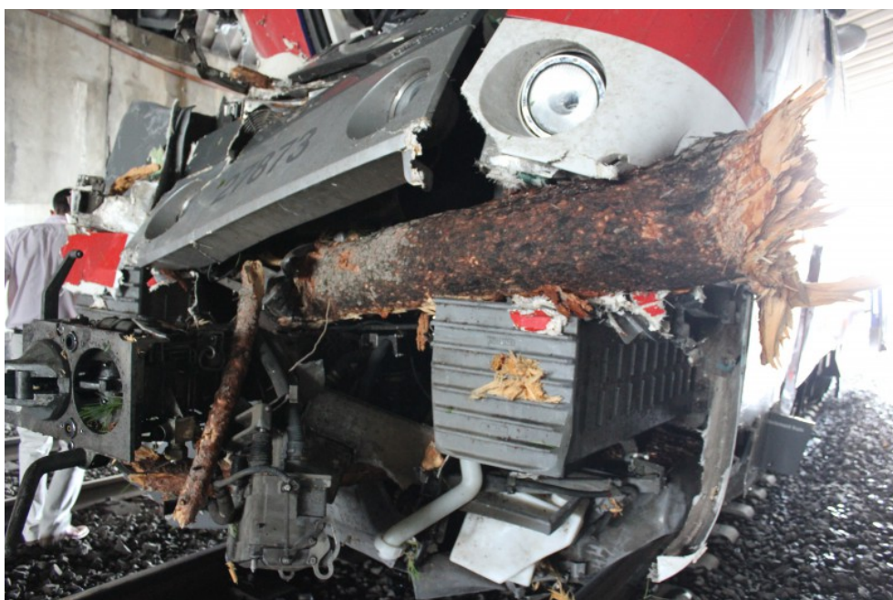
Figure 4b. Accidents régulièrement mentionnés. Accident du TER consécutif à la chute d'un arbre sur la commune de Saint Aunès en 2016.
