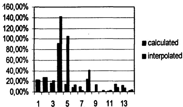
**Figure 5** Écarts de hauteurs d'eau sur le réseau de Bapaume avec BSV.
