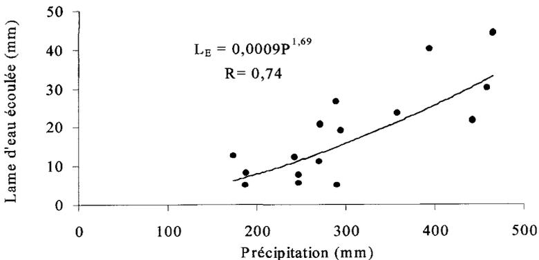
**Figure 6** Relation liant la lame d'eau écoulée aux précipitations annuelles.
