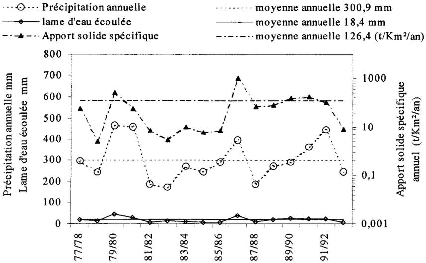
**Figure 5** Variations inter-annuelles des précipitations, des lames d'eau écoulées et des apports solides spécifiques.
