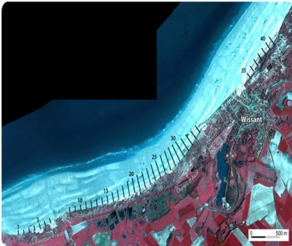
Figure 3. Evolution du trait de côte de la Baie de Wissant entre 1949 et 2000 (d'après Aernouts, 2005). Les courbes représentent la position du trait de côte en 1977 et en 2000 par rapport à celle de 1949. La photographie aérienne est un orthophotoplan infrarouge datant de 2000 fourni par l'Espace Naturel Régional du Nord-Pas-de-Calais.
