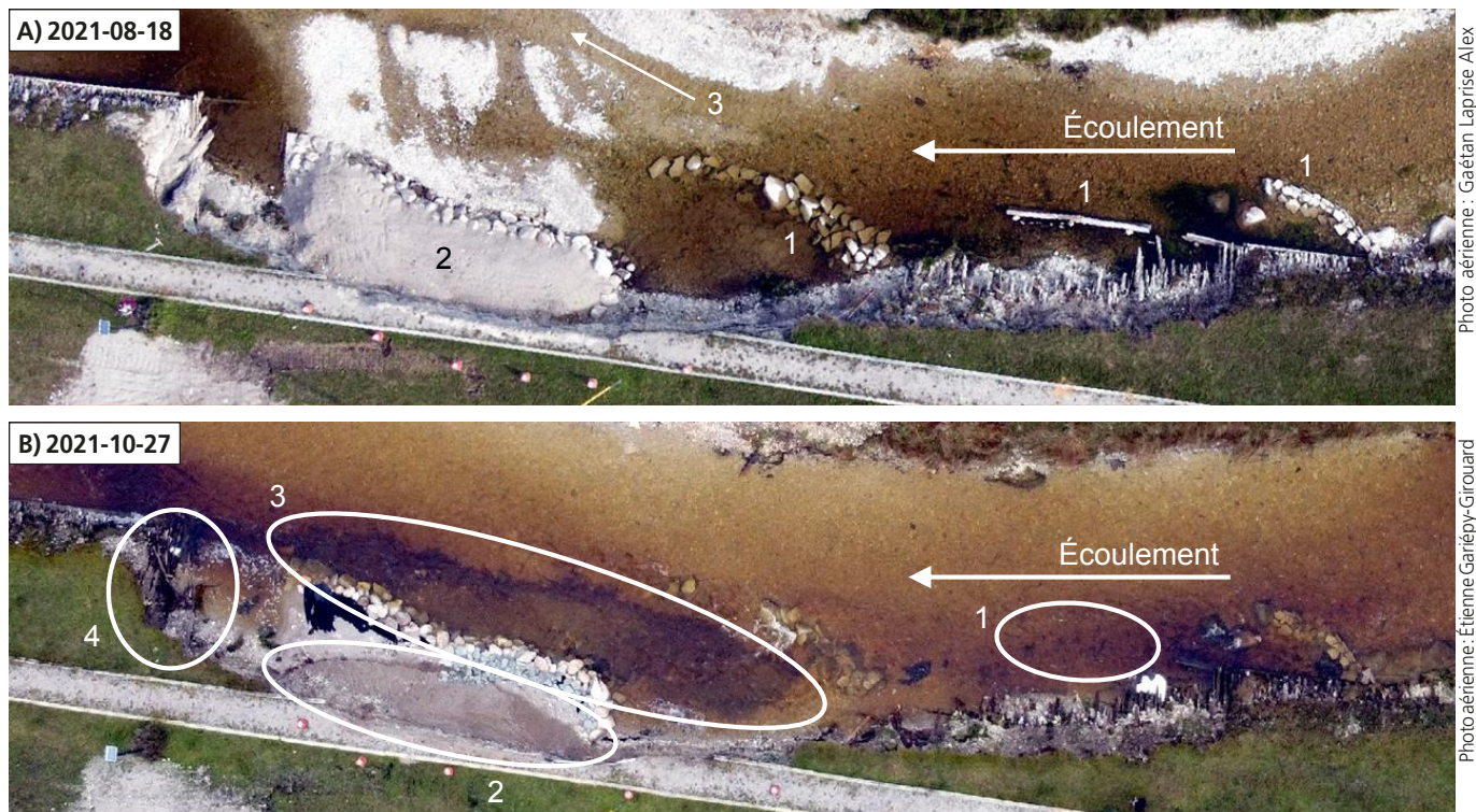
Figure 6. A) Photographie aérienne des aménagements fauniques réalisés au niveau du coude (350 m) dans le canal Saint-Georges, le 18 août 2021, où on voit (1) les déflecteurs de déviation du courant, (2) le monticule de sédiments en berge et (3) le chenal préférentiel dragué; B) photographie aérienne prise au même endroit le 27 octobre 2021, montrant les conséquences morphologiques des travaux après un événement de crue de récurrence annuelle: (1) destruction d'un déflecteur de bois, (2) érosion majeure de l'ouvrage de protection, (3) incision du lit (affouillement) et (4) érosion de la berge à l'extrémité aval de l'ouvrage (effet de bout).
