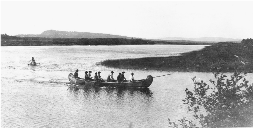
Le canot d'écorce « rabaska » peut porter trois tonnes de marchandises. Wemotaci, vers 1911 (Source : Fonds George Burnham Boucher, HBCA 1985/33/84)
