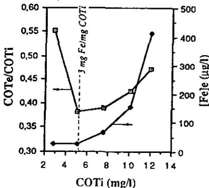
**Figure 5** Coagulation de AFC préoxydé au bioxyde de chlore (0,6 mg ClO<sub>2</sub>/mg COTi) par 15 mg l<sup>-1</sup> Fe(III) à pH = 5,5 et à 20 °C.
