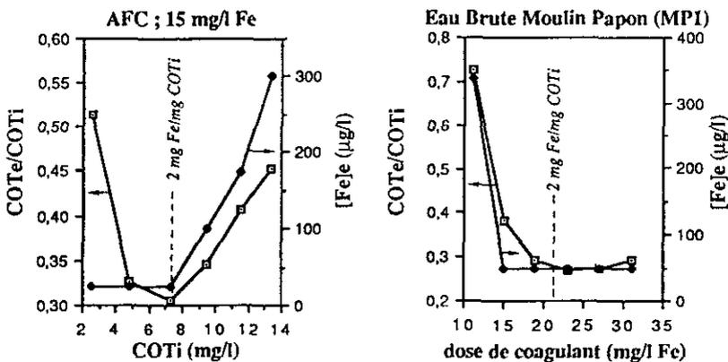
**Figure 3** Coagulation à pH = 5,5 et à 20 °C de AFC par 15 mg l<sup>-1</sup> Fe(III) et d'une eau brute Moulin Papon (MP1)
