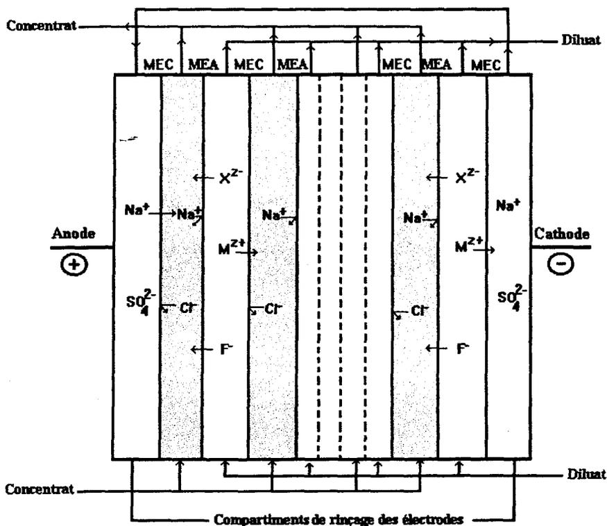
**Figure 1** Représentation schématique du procédé d'électrodialyse.
