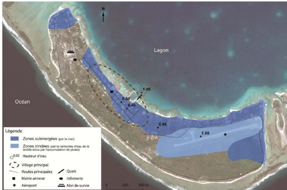
Figure 5. Cartographie de la submersion engendrée par le cyclone Veena en avril 1983 sur l'île de Tuherahera, Tikehau /Areas flooded by Veen cyclones in April 1983 on Tuherahera island, Tikehau atoll.
