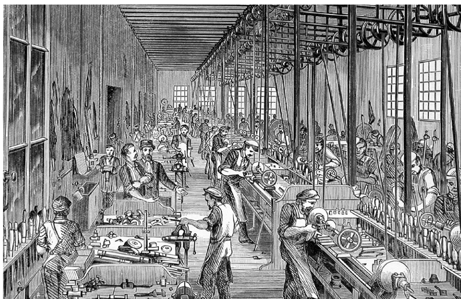
L'intérieur de cette entreprise non identifiée présente l'une des sources de blessures et de décès au travail : les courroies, non protégées, transmettant le pouvoir de la machine à vapeur aux machines-outils. Gravure de John Henry Walker, c. 1850-1885. (Musée McCord, M930.50.8.79).
