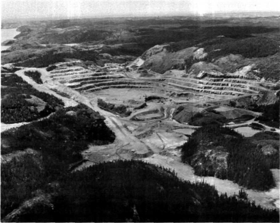
Photo 1 L'exploitation minière de la société F.T.Q. aux lacs Allard-Tio. Extraction à ciel ouvert par la méthode de « gradins ». Dans la partie supérieure gauche, l'usine de concassage, le bâtiment administratif et le terminus de la voie ferrée. Plus à l'ouest, une partie du lac Allard. À remarquer également la sub-horizontalité du plateau laurentien.
