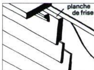
Illustration A Planche de frise posée sous la corniche. La planche est feuillurée ou posée sur des fourrures pour recouvrir le revêtement et ainsi assurer une meilleure étanchéité.
