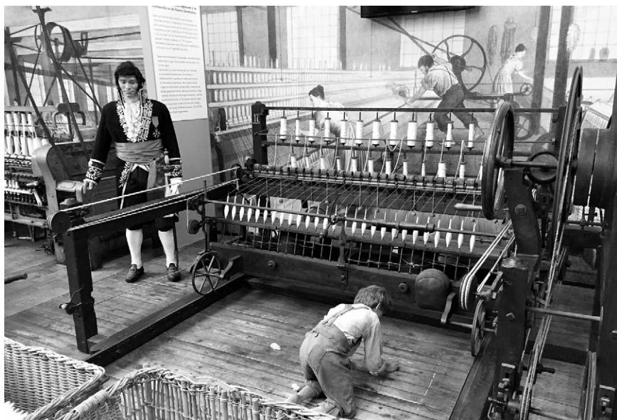
Figure 6. La machine à filer « mule jenny », seul exemplaire conservé dans le monde, dans le Industriemuseum à Gand. © Patrick Viaene
